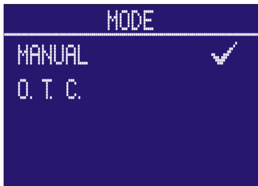
12. imagine: Selectați modul de funcționare (manual sau OTC)
