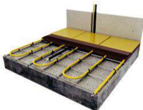
Instalarea pe plasă ranforsată cu coliere
